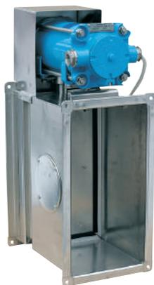
Клапаны для районов с морским климатом и помещений с повышенной влажностью изготавливаются из нержавеющей стали. Электромеханический или реверсивный привод BELIMO помещен в оболочку, имеющую степень защиты IP 66. Корпус клапанов выполняется прямоугольного сечения.
