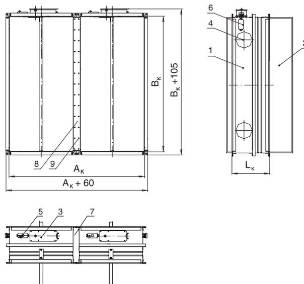
$$F_k = (A_k - 138)(B_k - 9)/10^6, \text{ м}^2 \text{ для КЛОП}^\circ\text{-2(60/90/120)} \quad (9)$$
