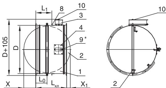
Клапаны КЛОП-2(60/90/120) диаметром 100, 125 и 140 мм изготавливаются с продольным расположением привода.
