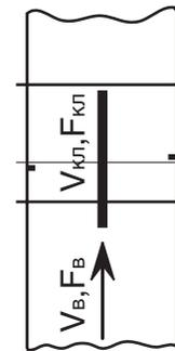
Значения коэффициентов  $\zeta_B$  отнесены к скорости во внутреннем сечении клапана (воздуховода)  $F_B = A \times B, \text{м}^2$ .
