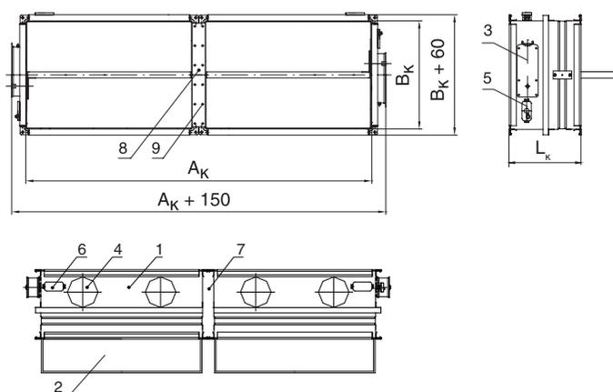
$$F_k = (A_k - 78)(B_k - 39)/10^6, \text{ м}^2 \text{ для КЛОП}^\circ\text{-2(60/90/120)} \quad (8)$$
