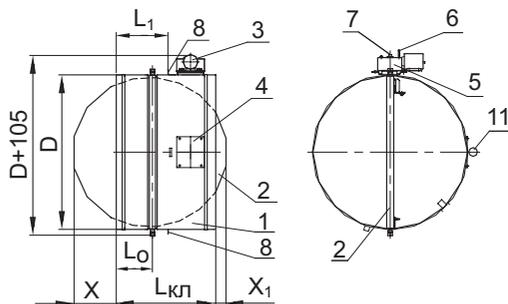
$L_1$  – длина корпуса НО клапана, устанавливаемого в строительную конструкцию или покрываемого огнезащитой;
