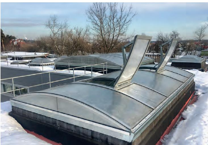
Для проведения климатических испытаний изготавливаемых дымовых люков и зенитных фонарей на территории производства ВИНГСМ построено экспериментальное здание с установленными в покрытии образцами изделий различной конструкции. Целью испытаний является оценка влияния климатических факторов на работоспособность изготавливаемых изделий в условиях, максимально приближенных к реальным условиям их эксплуатации.
