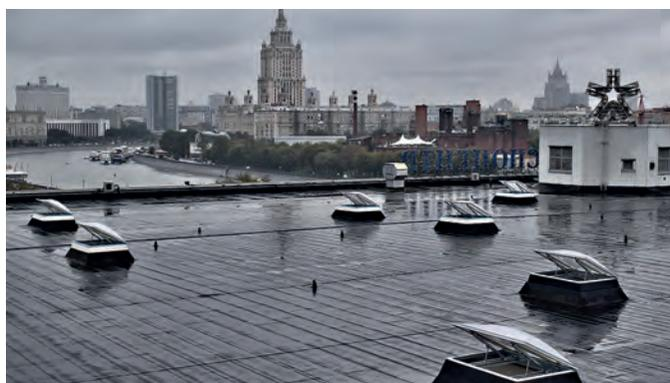
Большое внимание компания уделяет качеству выпускаемых изделий. С этой целью на территории производственного комплекса построено экспериментальное здание для проведения климатических испытаний установленных в его покрытии образцов дымовых люков и зенитных фонарей различной конструкции. Результаты испытаний позволяют изготавливать изделия с улучшенными техническими и функциональными характеристиками.
